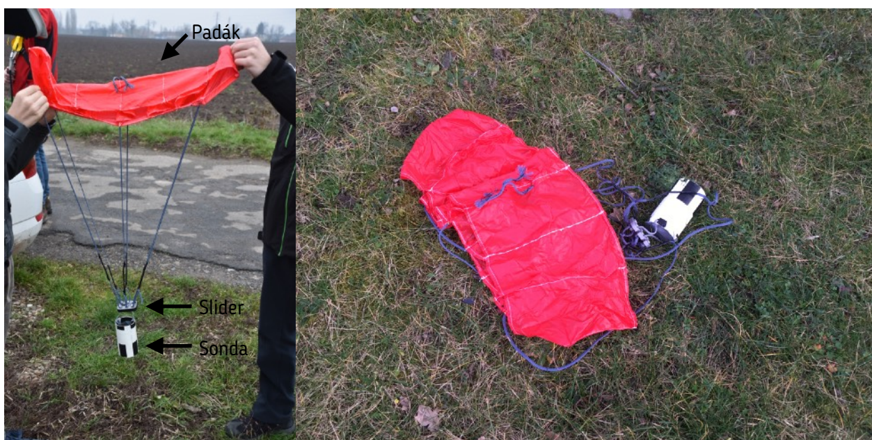
Obr. 90, 91: (zleva) Roztažený padák typu křídlo, padák po dopadu (foceno s balastní sondou)
