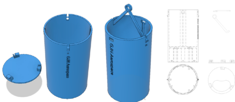
Obr. 6: CAD modely a náčrty obalu CanSatu Píseň kosmické (1)
