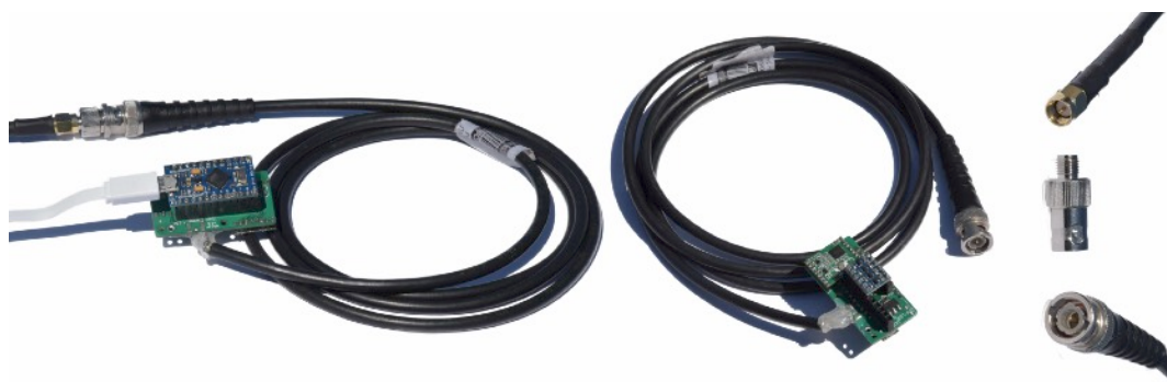
Obr. 79, 80, 81: (zleva) qbcan pozemní stanice připojena k anténě a PC, pozemní stanice qbcan, konektor BNC (nahore) s adaptérem (uprostřed) a konektor SMA na anténě (dole)
